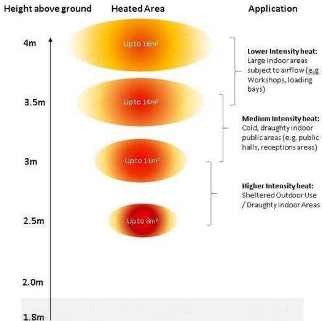
For permanent installasjon (dvs. uten stativ) må varmeren være plassert i en posisjon som tillater riktig og effektiv bruk, som også sikrer at varme deler ikke berøres ved et uhell. Den anbefalte installasjonshøyden på varmeren er 2,4 til 3,5m fra gulvet. Under ingen omstendigheter skal enheten installeres på mindre enn 1,8 meter fra gulvet. For utendørs bruk eller andre områder med luftbevegelse/vind kan den retningsbestemte infrarøde spredningen reduseres med 1/3 til 1/2.
